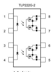
1, 3 : Anode 2, 4 : Cathode 5 : Drain D1 6 : Drain D2 7 : Drain D3 8 : Drain D4
